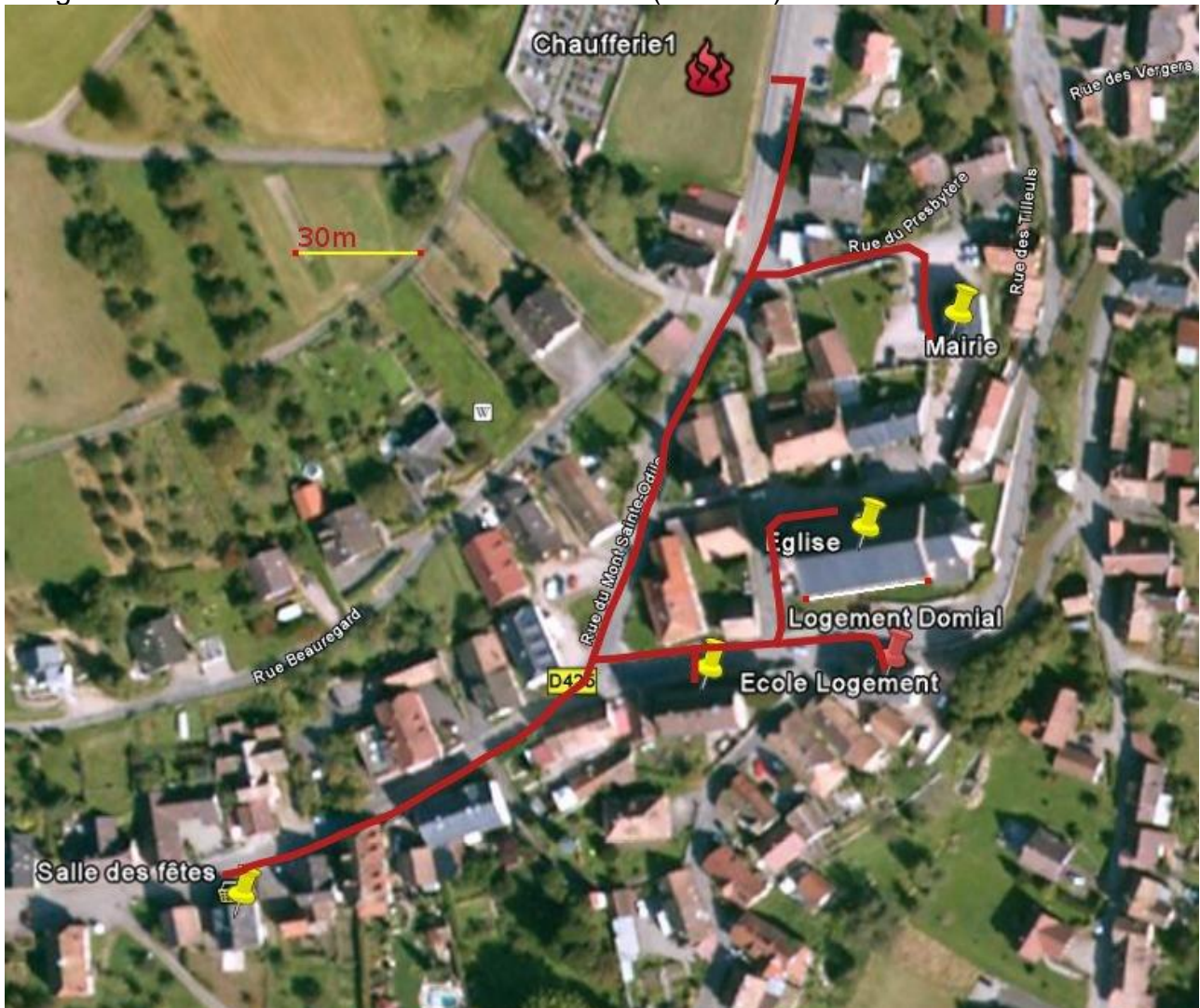
Figure 2 - Proposition réseau et emplacement chaufferie – Source : GoogleEarth
